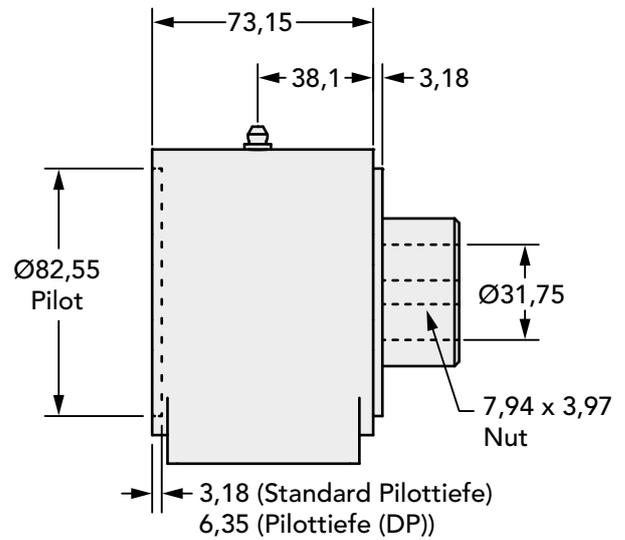
Für Pilotlänge (DP) entfernen Sie den Sicherungsring.
